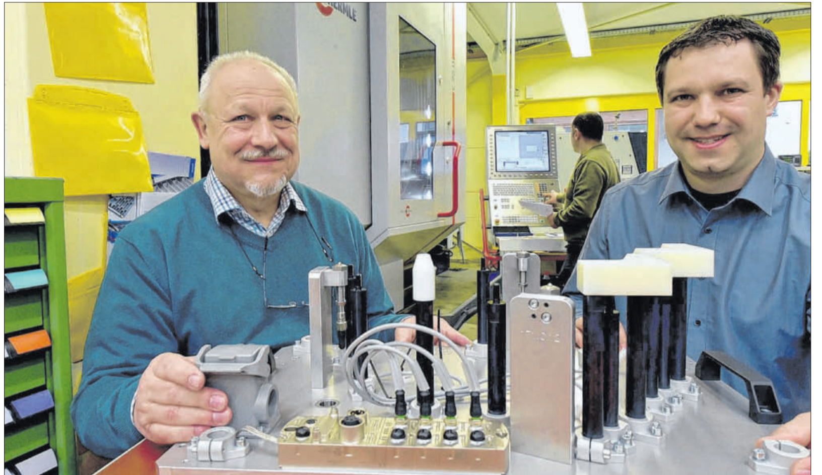
Gerd Ulmer (links) und sein Sohn Matthias führen den Betrieb G. Ulmer Automation in Hohenhaslach mit insgesamt 25 Mitarbeitern. Hier zeigen sie einen Montagestand für Zylinderköpfe. Foto: Martin Kalb
